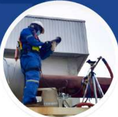
การตรวจวัดคุณภาพอากาศ ในปล่องระบายอากาศ
